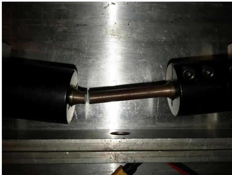
Figura 17: Corpo de prova de aço 1045 de 1/4" após 3 minutos rodando a 20.000 rpm com momento fletor considerável aplicado sobre ele. Como a seção de menor área estava muito longa nessa amostra, a ruptura não foi no centro, foi perto de um dos filetes laterais, onde houve concentração de tensões.
