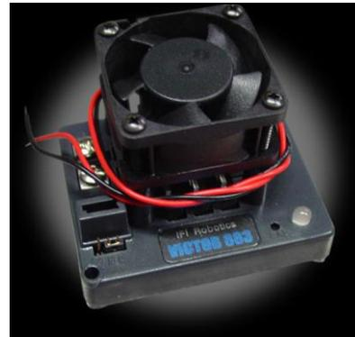
Figuras 14 e 15: Sinal de PWM gerado pelo testador de servo, enviado para o controlador de velocidade IFI Victor 884, reversível.
